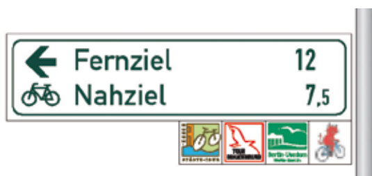
Abb. 89: Vollschild nach FGSV-Standard mit eingehängtem Routenhinweis
